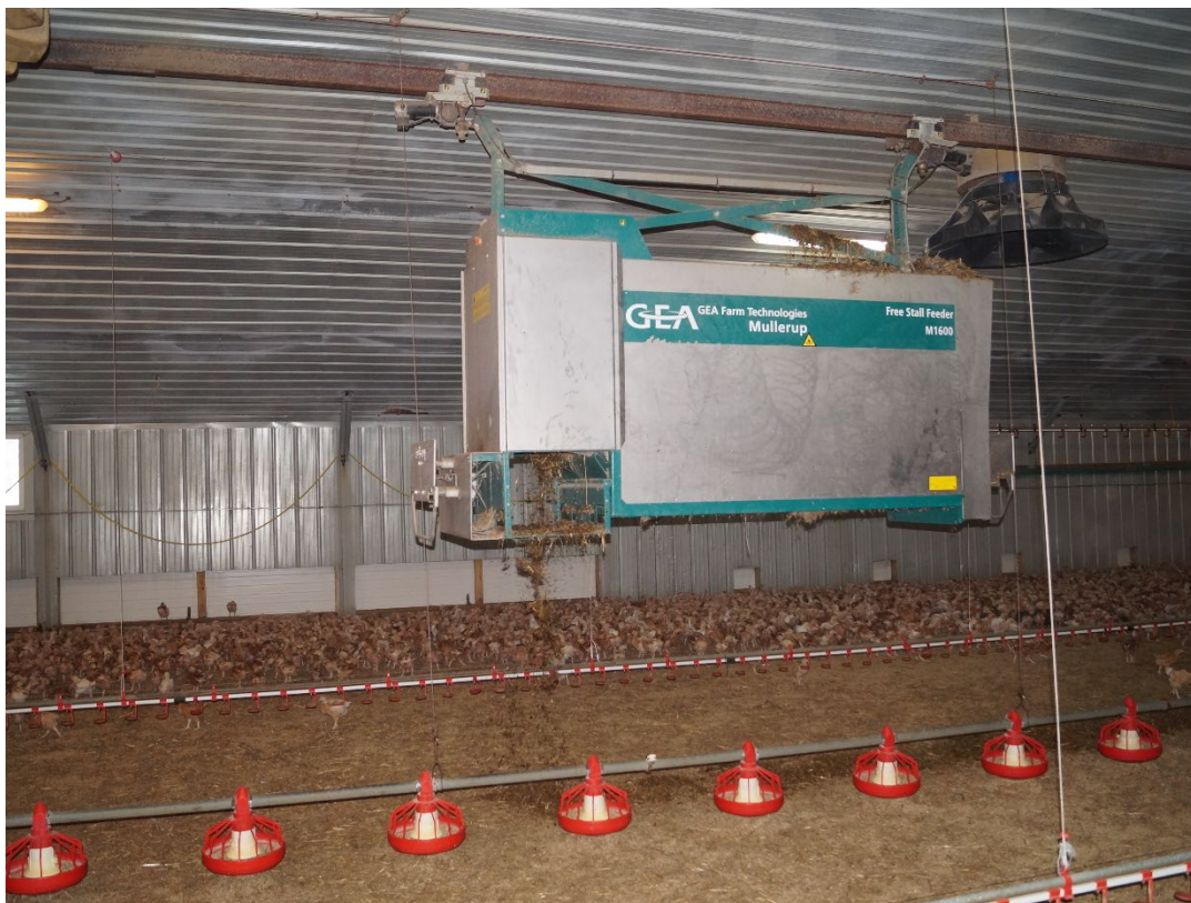
Billede 13. Grovfoderrobot, der automatisk tildeler grovfoder flere gange om dagen.
